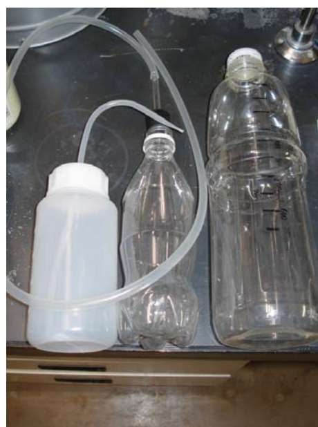
写真10. バブ消火器・気体捕集用の装置
