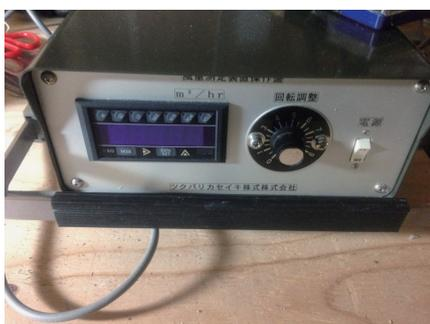
(a) 風量測定装置操作盤
