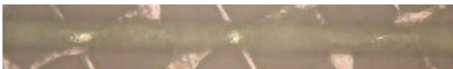
図 4.5 スクリーンマスク 30 \mu\text{m} 開口部へのペースト U の充填 ,FR=93%
