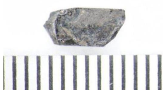
図 3.5-6. \text{Ba}(\text{Fe}_{0.9}\text{Co}_{0.1})_2\text{As}_2 の測定試料．紙面方向は[001]面，削りだした[110]面は，写真の上下端．
