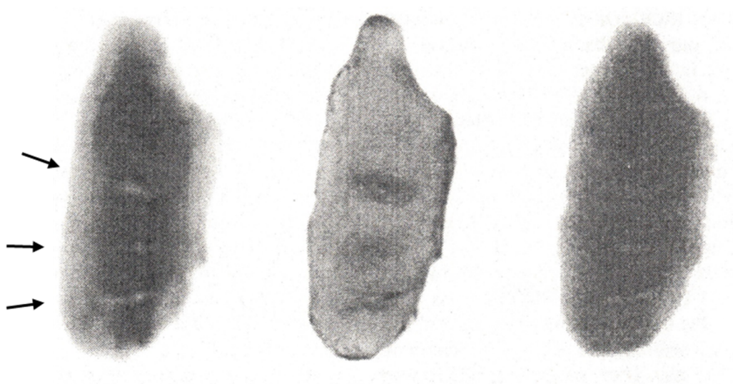
図 5-1 . 炊飯米の NMR マイクロイメージングの透過像(左)と 可視光透過像(中央), X 線透過像(右) 矢印は空洞の位置を示す
