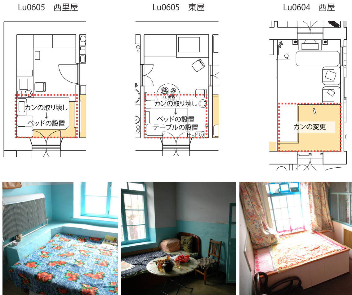
図 4-2 暖房に関する改修（カンの取り壊し（左、中央）、カンの変更（右））
