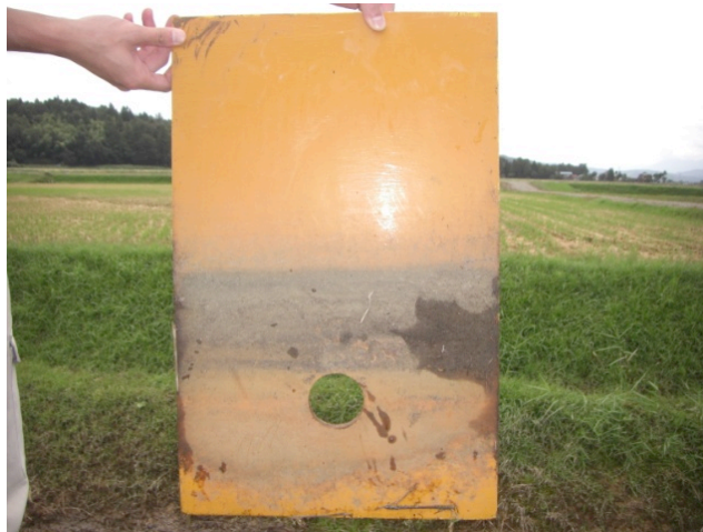
図 2.2 垂直設置型落水量調整板（長岡市深沢地区，上越市三和地区）
