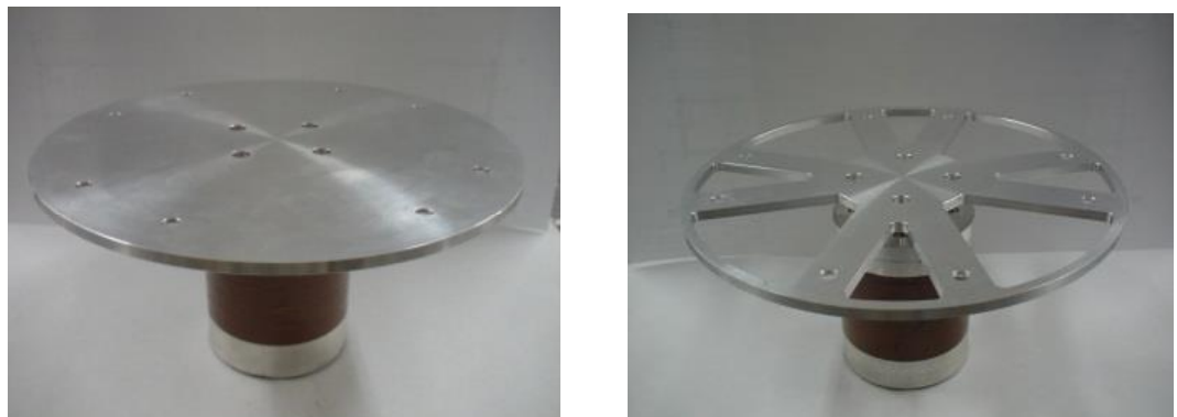
図 4-6-1 ターンテーブルの低慣性モーメント化前（左） 後（右）
