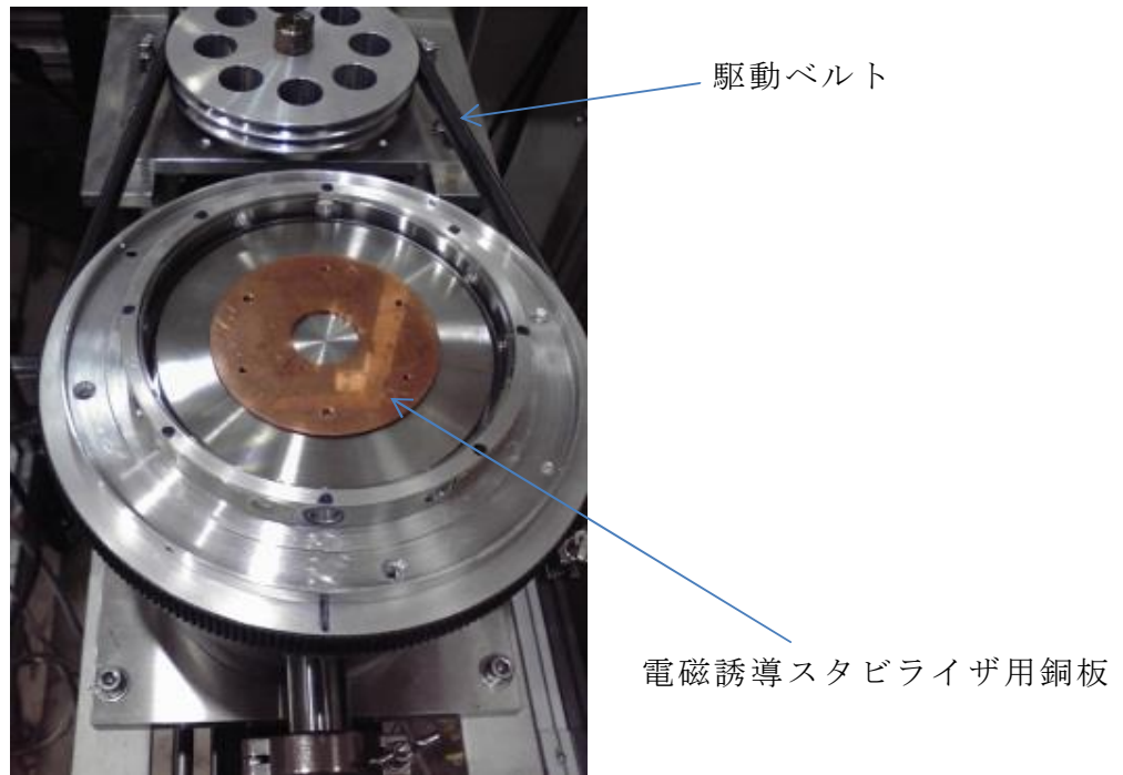
図 5-3-3 低慣性スラスト浮上実験機 駆動部の外観
