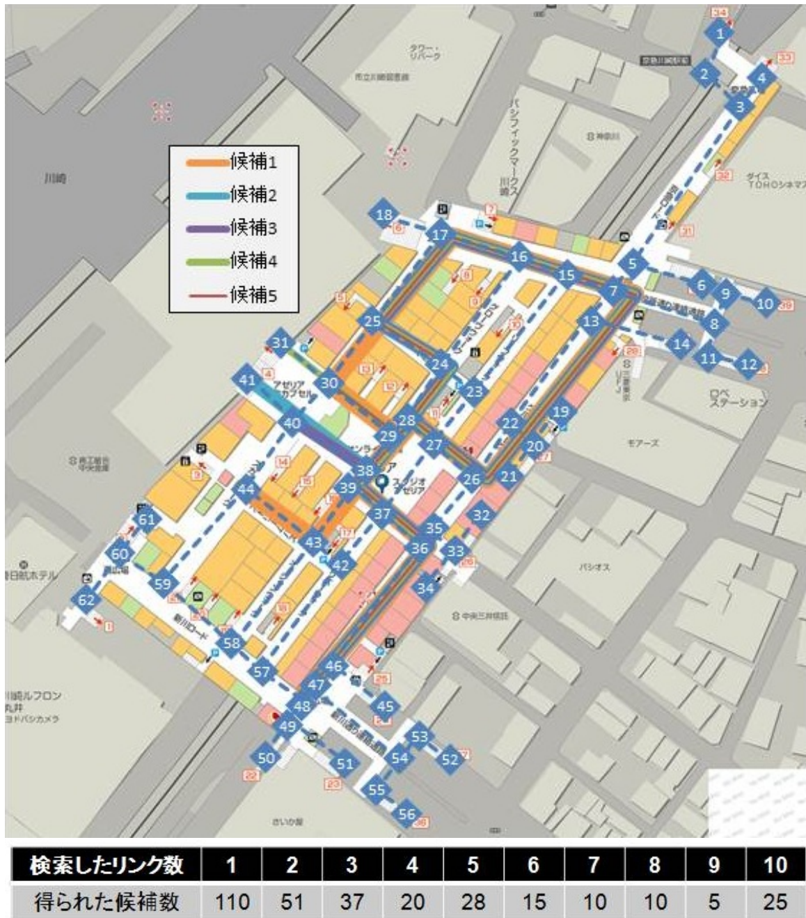
図 2.16 10 リンクから成るルートを行きし形状検索手法 1 により経路を推定した結果
