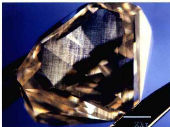
Fig.4-(1)-75. Ⅱa 型天然ピンク・ダイヤモンドに見られる“タタミマツ”構造
