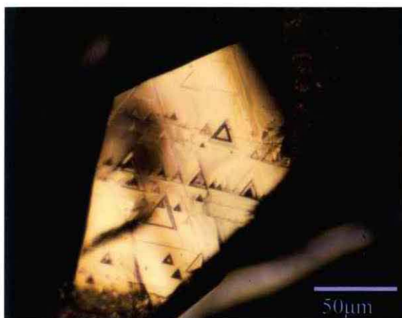
Fig.4-(1)-4. ピンクダイヤモンドのナチュラル に見られるトライゴン
