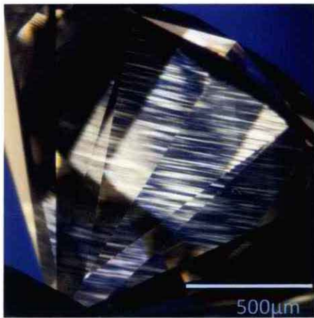
Fig.4-(1)-76. Ⅱb 型天然ダイヤモンドの“タタミマット”構造
