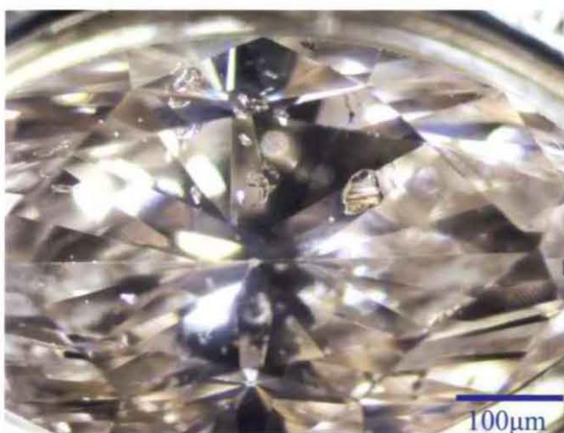
Fig.4-(1)-30. ピンクダイヤモンド中のパイロープ/ アルマンディン inc.
