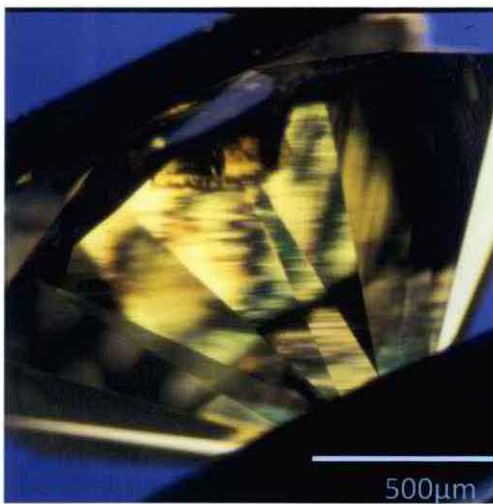
Fig.4-(1)-79. Ⅰb 型天然黄色ダイヤモンドに見られる“タタミマット”様の歪複屈折
