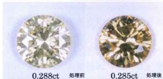
Fig.4-(3)-16. I a 型淡黄色ダイヤモンド (a) 処理前 (b)HPHT 処理後
