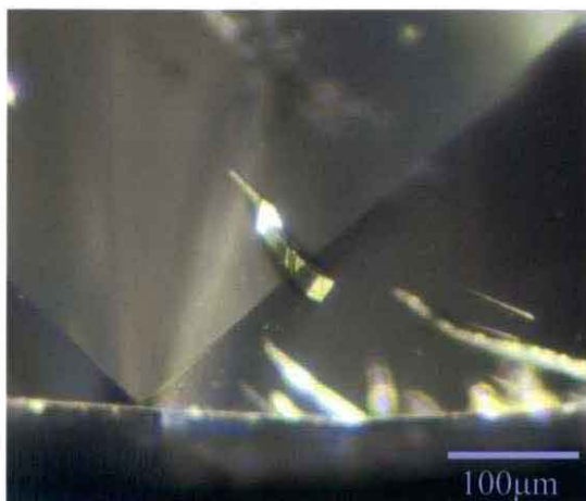
Fig.4-(1)-13. クラウンファセットに見られる四角形の断面を有するエッチピットに伴う緑色の irradiation stain
