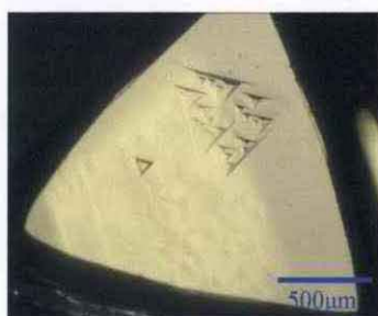
Fig.5-1. \{111\} と逆向きの三角形 底の尖ったP型
