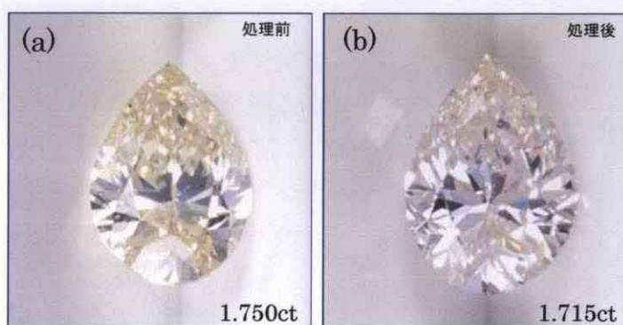
Fig.4-(3)-7. II型褐色ダイヤモンドの HPHT 処理前後 (a) 処理前 (b)処理後
