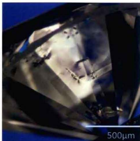
Fig.4-(1)-71. 微細な包有鉱物周囲の歪複屈折
