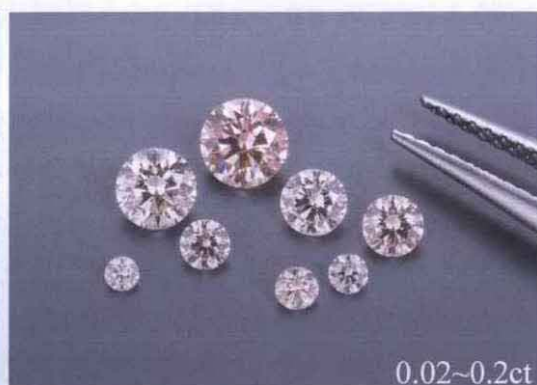
Fig.4-(4)-30. CVD 法合成ピンクダイヤモンド
