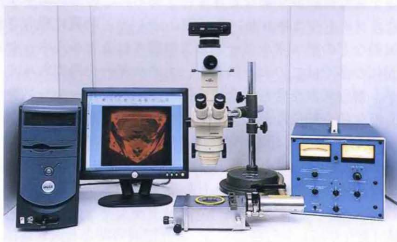
Fig.3-13. 本研究で使用した直接法による CL 観察システム このシステムで大量の試料の観察が可能となる
