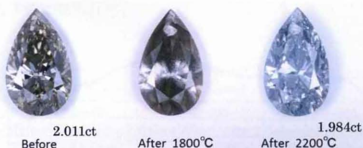
Fig.4-(3)-8. Ⅱb型褐色ダイヤモンドのHPHT処理前後
