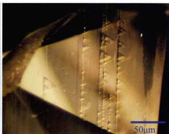
Fig.4-(1)-5. \{111\} 面に平行な Slip line に規制さ れて配列するトライゴン
