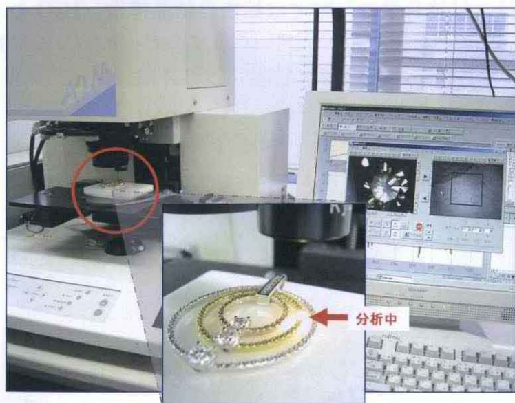
Fig.3-9. 赤外顕微鏡によるダイヤモンドジュエリーの測定状況
