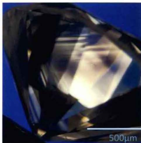
Fig.4-(1)-72. 成長時に形成された{1 1 1}面に平行な歪複屈折
