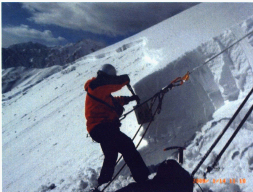
写真 3-1 雪崩破断面における積雪断面観測実施状況
