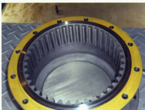
(a) 異常設定 WN 継手外筒
