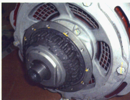
(d) 正常 WN 継手内側小歯車
