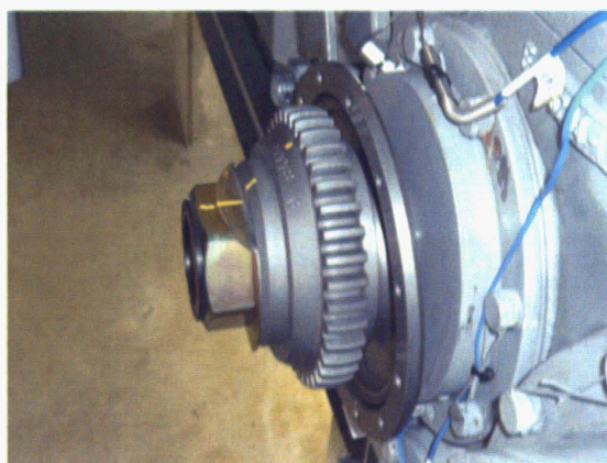
(b) 異常設定 WN 継手内側小歯車
