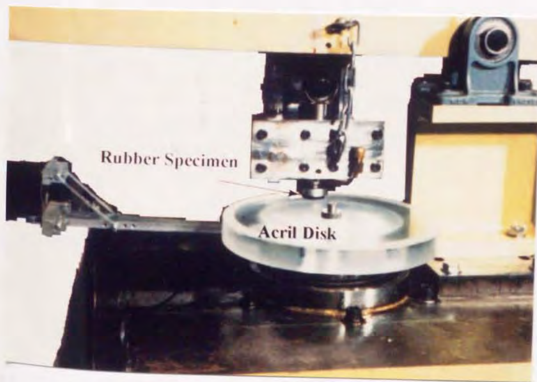
図 4.17 実験装置概略 (測定システム I)
