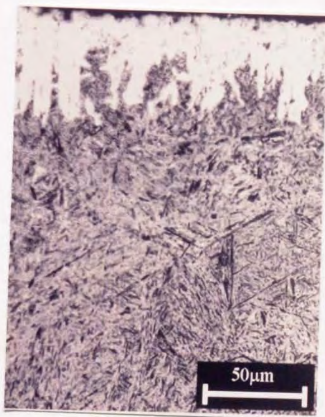
図 3.6 S45C 鋼の硼化物層
