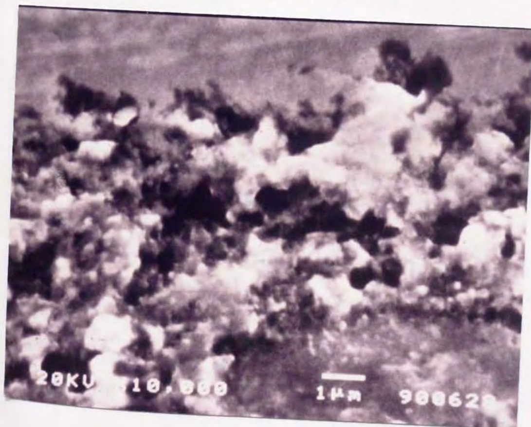
図 3.39 TiN/SKH51 の SEM 像 ( Main RF Power : 0.5KW)
