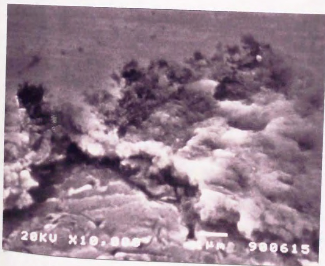
図 3.43 TiN/SKD11 の SEM 像 (Main RF Power : 1.5KW)
