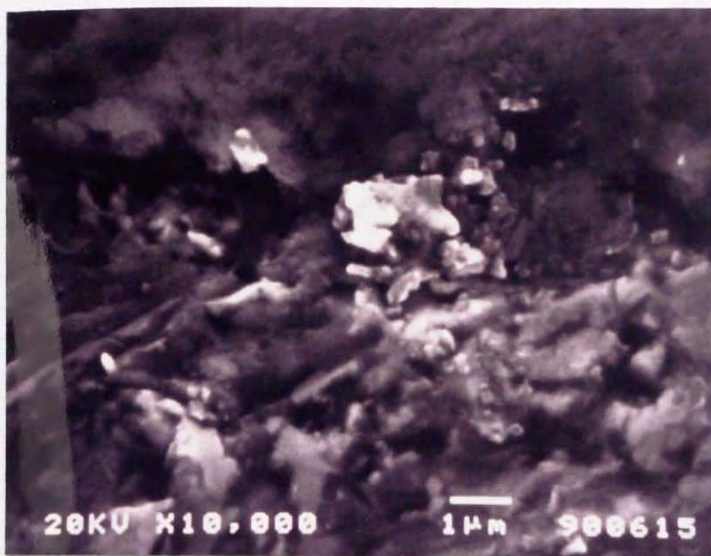
図 3.40 TiN/SKH51 の SEM 像 (Main RF Power : 1.5KW)
