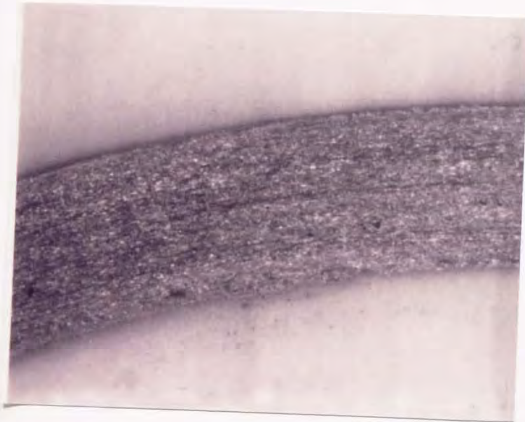
図 3.14 試験後のディスク摺動面 (摺動速度 :4.71m/s 接触圧力 :5.8MPa)
