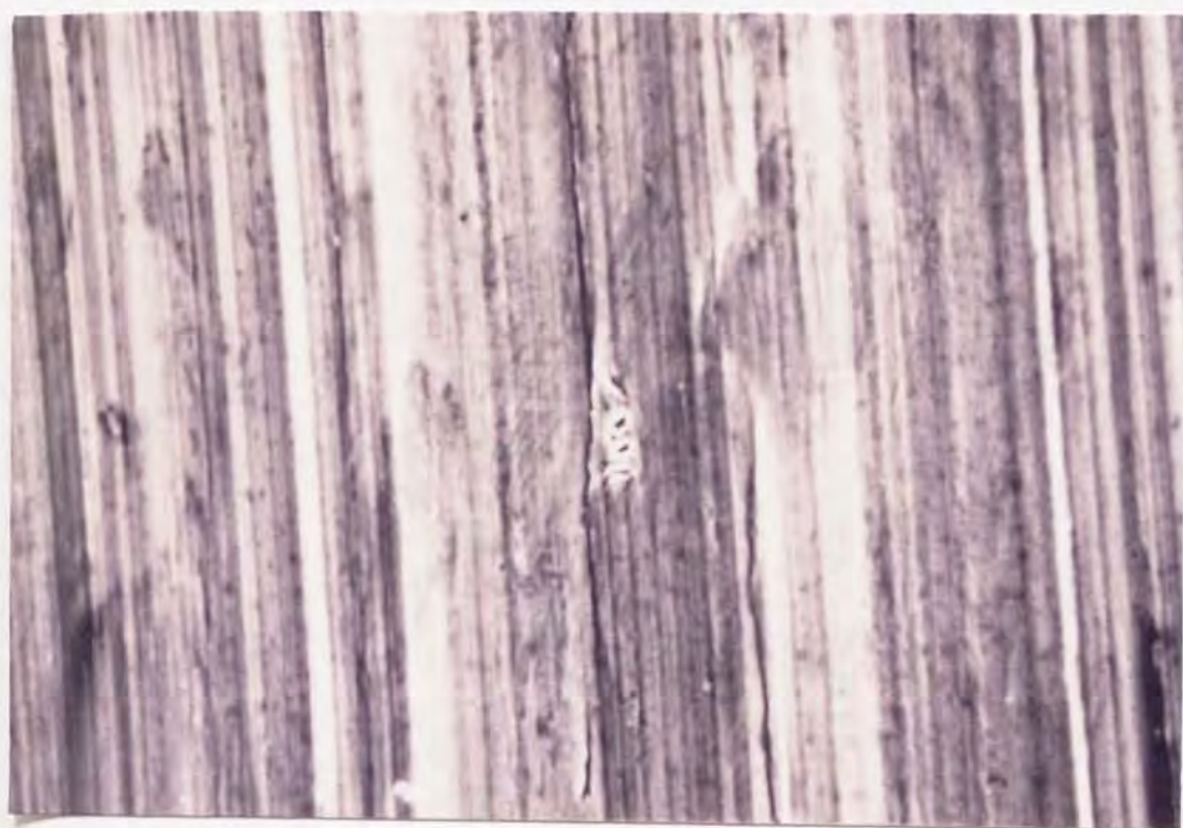
図 3.28 試験開始 11 分後の硼化处理鋼接触表面
