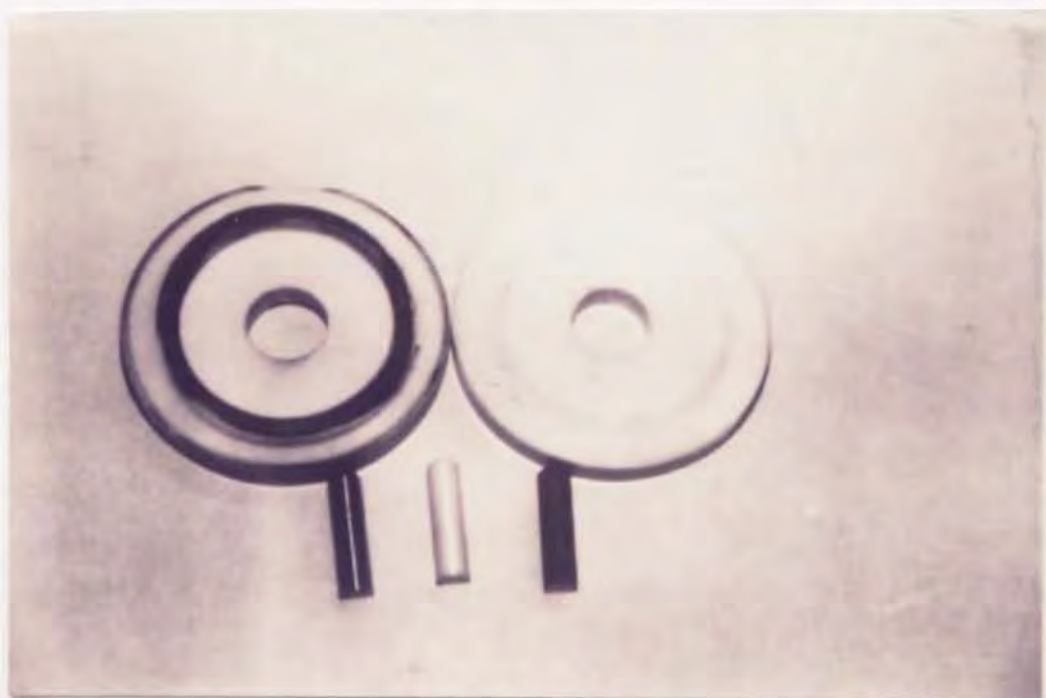
図 3.10 実験後のディスク及びピン
