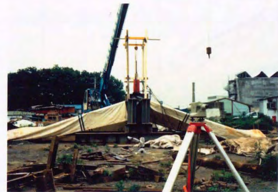
写真-2. 1 引抜き試験の実施状況 (於、関東ローマ層。S-17ノカー)
