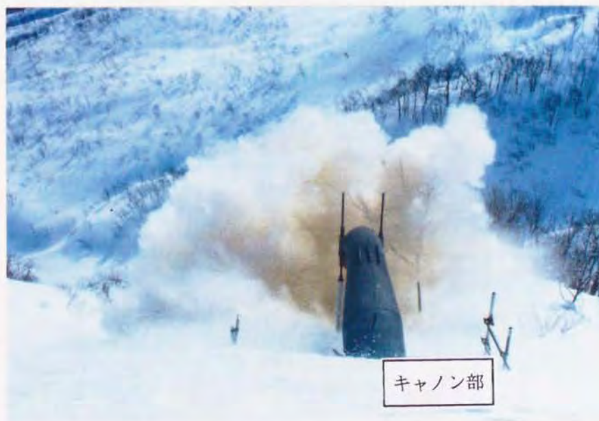
図5-2 ガゼックスキャノン部 爆発直後の状況写真、爆発によるキャノン部直下に雪煙が上がっている状況がわかる
