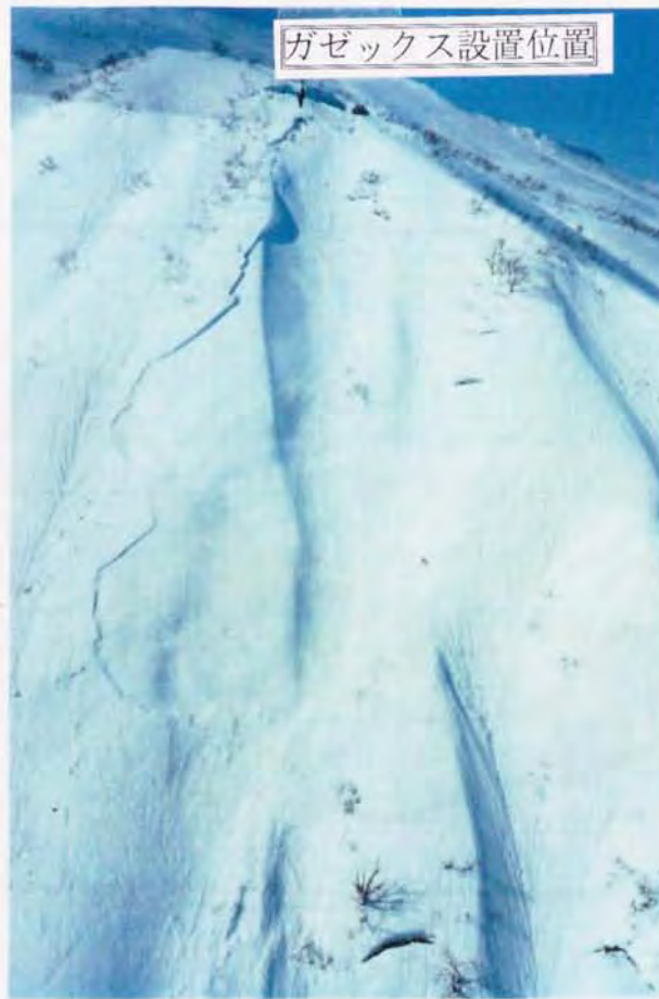
図5-17 1992年2月27日にA-1地点で発生した大規模な雪崩 実験直後に撮影したもの 斜面上部のキャノン部設置地点から水平方向に約100m、斜 面方向に約300mの破断面が確認される
