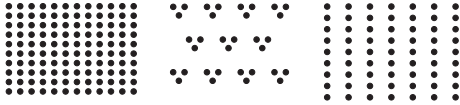
図 1 面パターン例。左から、格子、V 字千鳥格子、縦ストライプ
