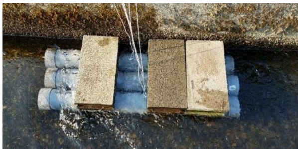
図 5.1-1 農業用水路に設置した SS サンプラー
