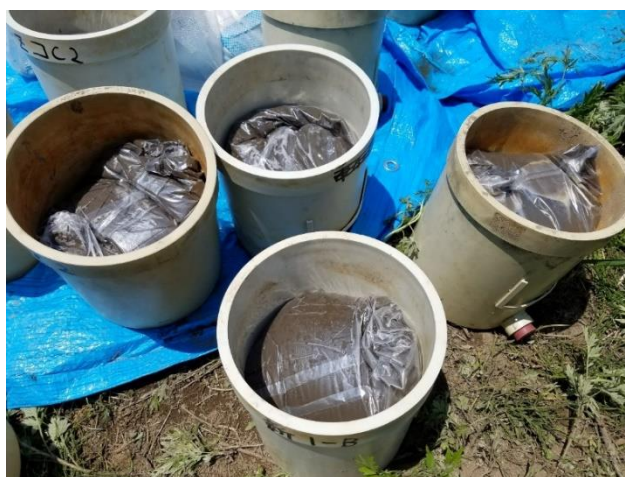
図 4-3 マルチングしたポット. 灌漑水中に含まれる懸濁態放射性 Cs の土壌への付加を除去するために、土壌をビニール袋で覆った.
