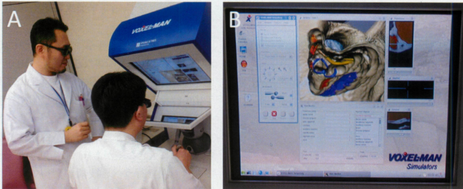
図3 パーチャルリアリティ (VR) の代表であるボクセルマン。A: 外観。3D眼鏡を装着し擬似的な3次元画像に対し、模擬手術をしている。B: プレインストールされている例での実際の画面。各重要構造物は視認しやすいように着色してある。
