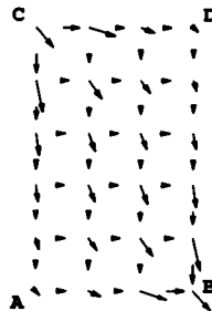
図11 逆相モード CPLA の電流分布 (0.28 GHz) Fig.11 Current distribution for odd mode of CPLA (0.28 GHz).
