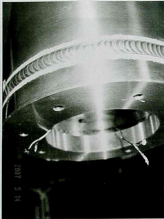
Fig.9 液体窒素温度でのアンカーのあと真空からのリード線 一番外側に室温へ出すための BNC への接続の写真を Fig.10 に示す。
