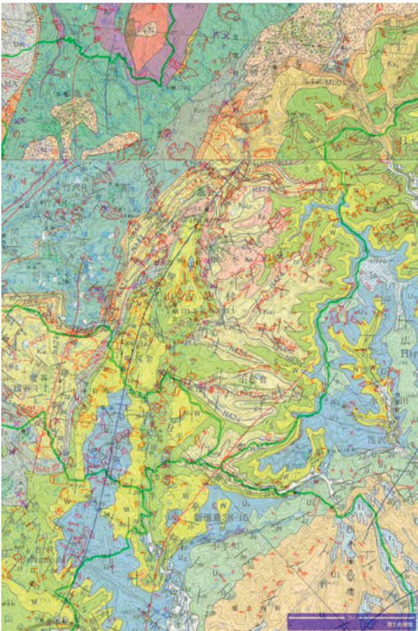
図-3 褶曲軸と地すべり・斜面崩壊分布状況 資料出典:5万分の1地質図幅「長岡」,地質調査所;5万分の1地質図幅「小千谷」,地質調査所;中越地震災害状況図,国土地理院
