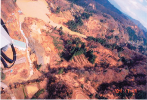
写真-5 ポンプによる緊急排水中の異常侵食の状況 (写真左手が緊急排水路)
