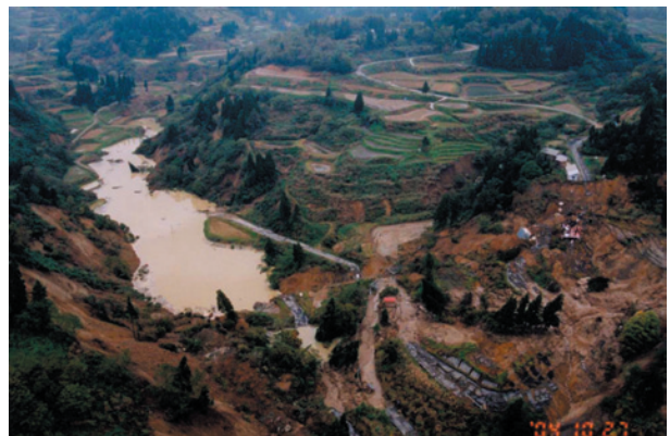
写真-10 寺野地すべり（写真右手前が地すべり、中央部に見られる道路は地すべり移動により切断され約30mのずれが生じた。）
