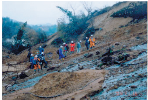
写真-9 主滑落崖で観察されたすべり面（約 20^{\circ} の傾斜を有する平坦な青灰色の砂質シルト岩の上面をすべり面とする典型的な流れ盤の地すべり。）
