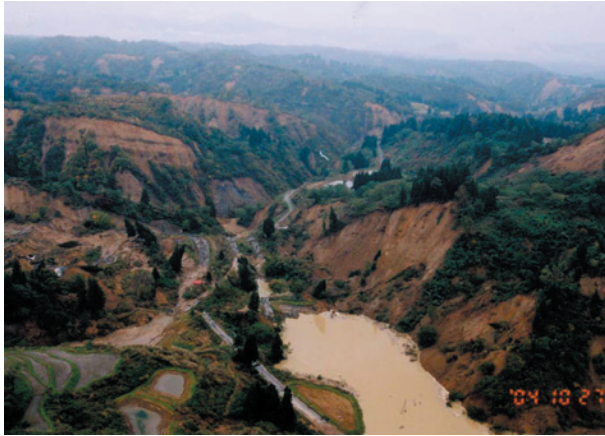
写真-11 寺野地すべり（左岸側が地すべり、右岸側は斜面崩壊）
