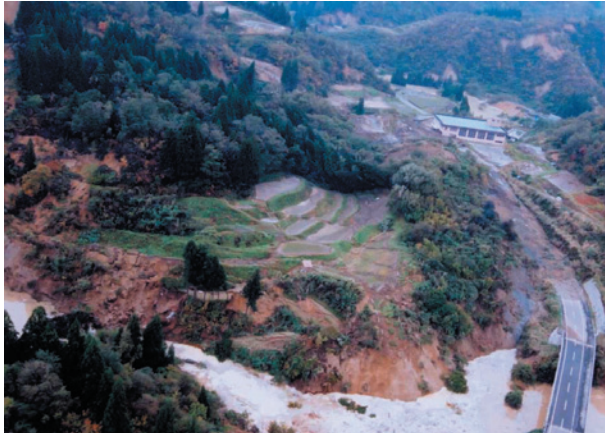
写真-1 東竹沢地すべりによる河道閉塞
