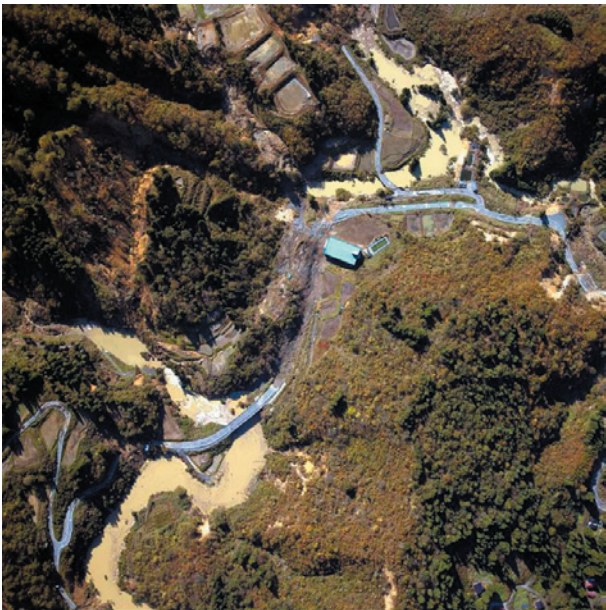
写真3. 東竹沢の地すべりによる河道閉塞(10月28日、アジア航測(株)撮影)
