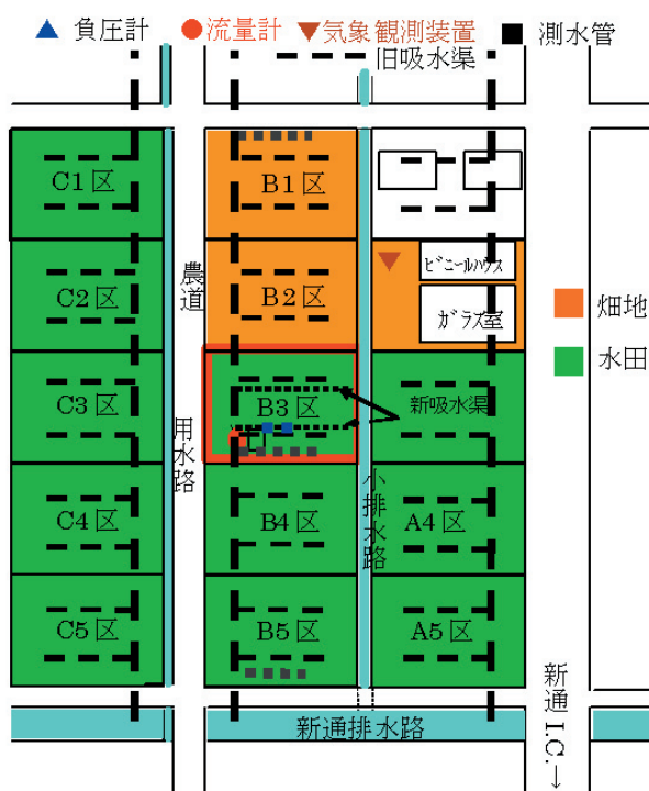
図 12 FC 新通の集水渠と新・旧吸水渠
