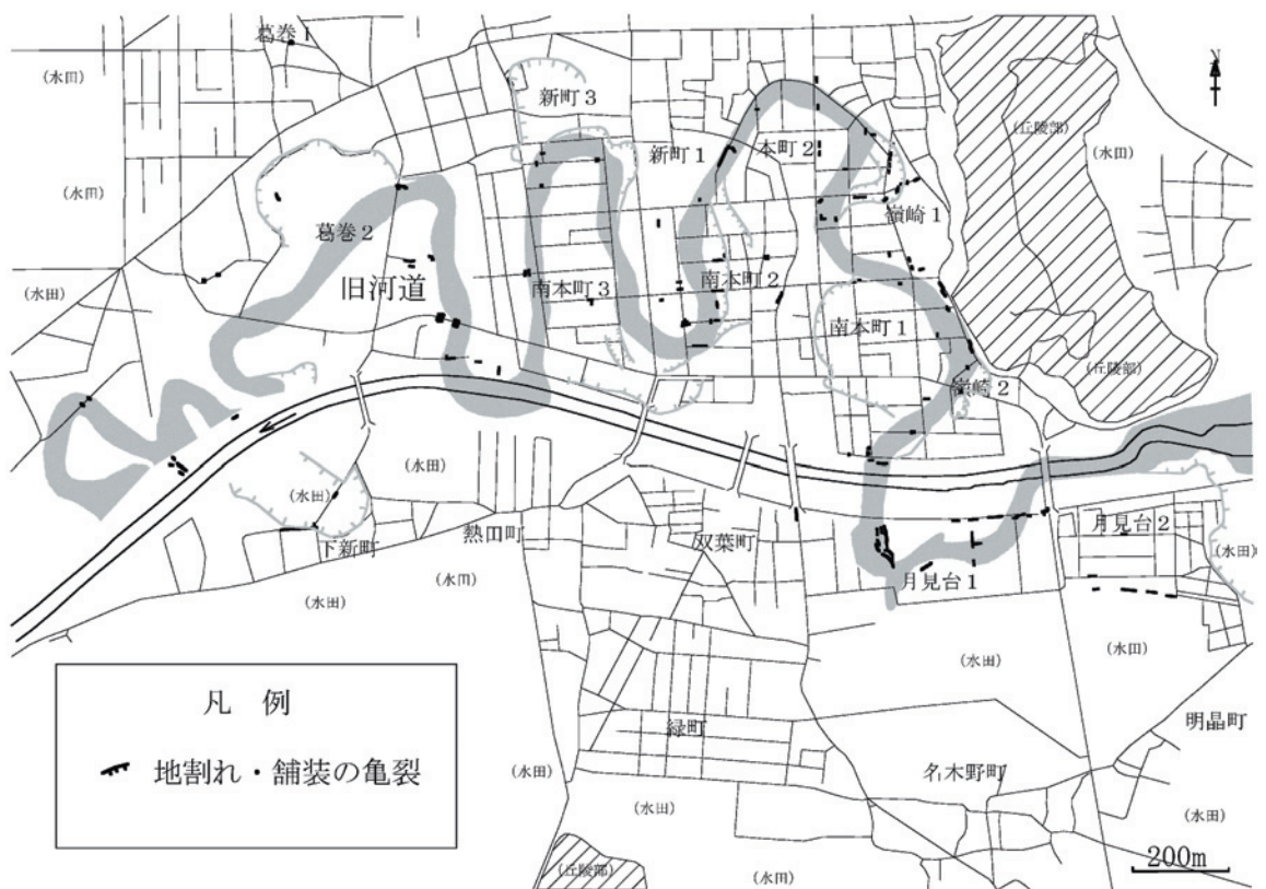
第 17 図. 地割れ・路面等の亀裂発生箇所
