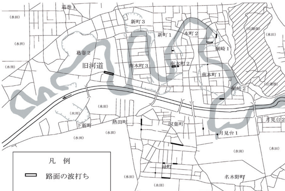
第 15 図. 路面の波打ちの発生箇所
