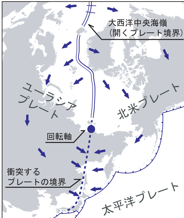
図2. 北極からみた地球上のプレート境界. ユーラシア-北米プレート境界は北極海から大西洋中央海嶺となっており、裂ける境界となっているが、ロシア極東から日本海東縁にかけては衝突境界へと変化している。
