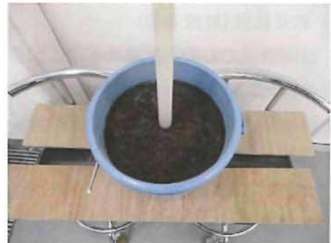
図 2-4 較正試験(湿潤過程)の様子 脱塩水 4000ml 投入
