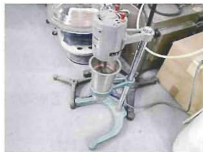
図 A-1 分散装置 (三洋試験機, SC-VS)
