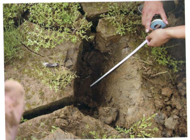
写真6 堆積した土砂の厚さ
