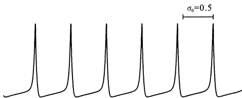
図 9 プラトー電位が観察されない回路振動子の時間波形 Fig. 9 Temporal waveforms of the circuit oscillators without plateau potential.
