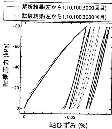
図-3 繰り返し載荷時における軸ひずみと軸差応力との関係。
