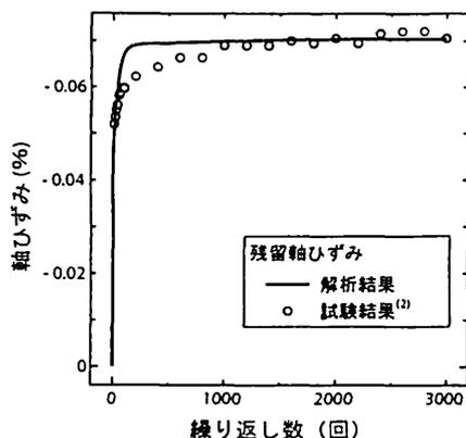
図-5 繰り返し回数と残留軸ひずみとの関係。(拘束圧 19.6(kPa), 試験結果は文献<sup>2)</sup>から抽出して図示.)
