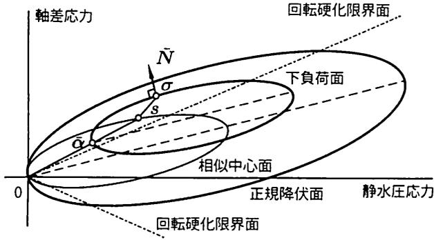
図-1 軸対称応力状態における下負荷面と各種応力の定義。
