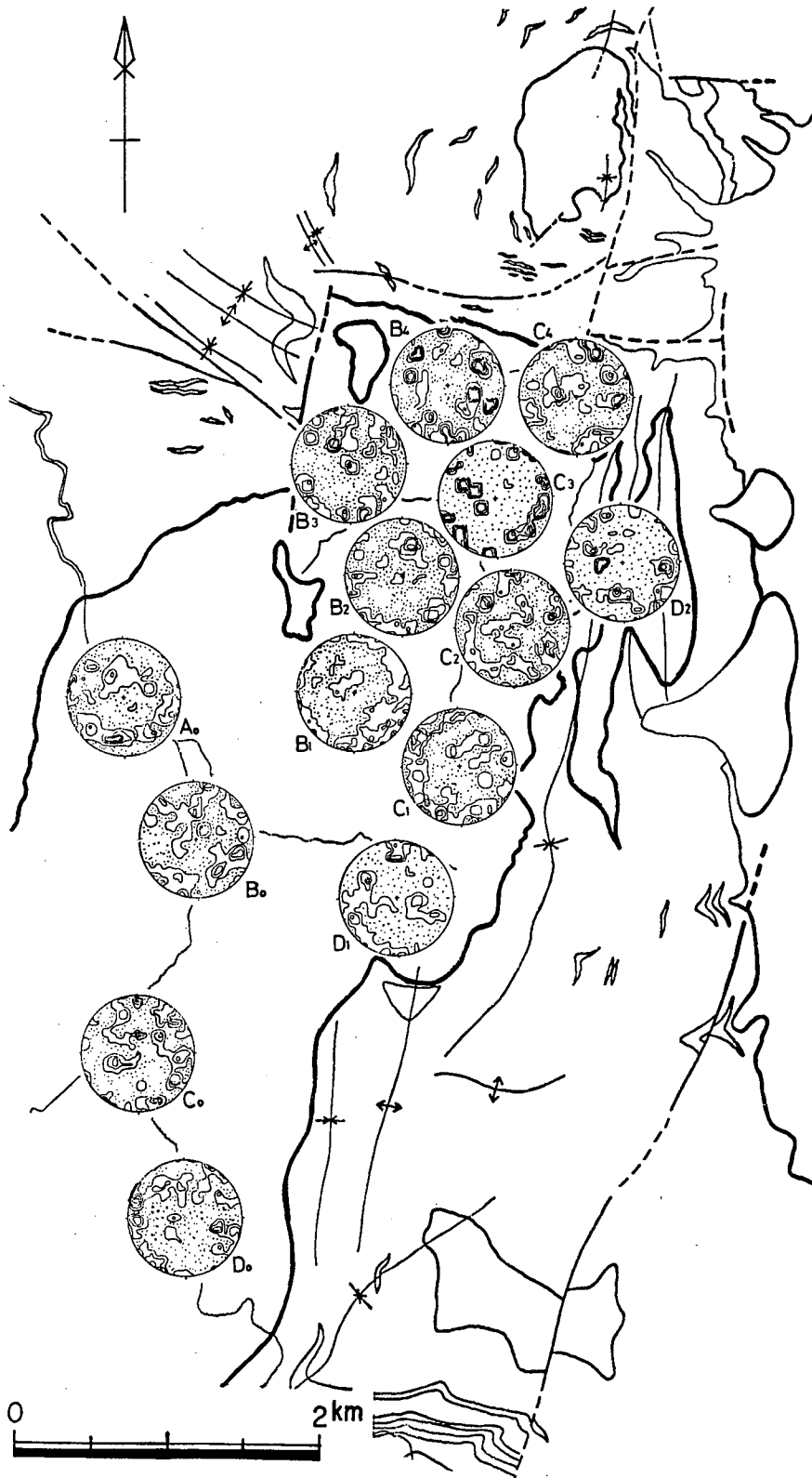
第 10 図. 清津峡岩体における節理面方位のコンターダイアグラム. 各領域内の節理面方位の極をシュミットネット上の上半球に投影. 等密度線間隔は 1—3—5—7—9%.
