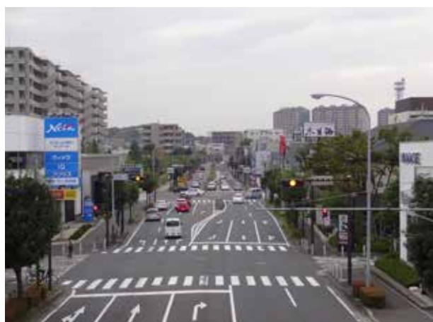
写真1：港北ニュータウンの景観（2013年10月15日 筆者撮影） 直線的で広い車道、埋設式で電柱がない街路、背後に見える大きな公園（緑地）、整然とした高層マンションといった要素がニュータウンらしい景観を特徴づけている。
