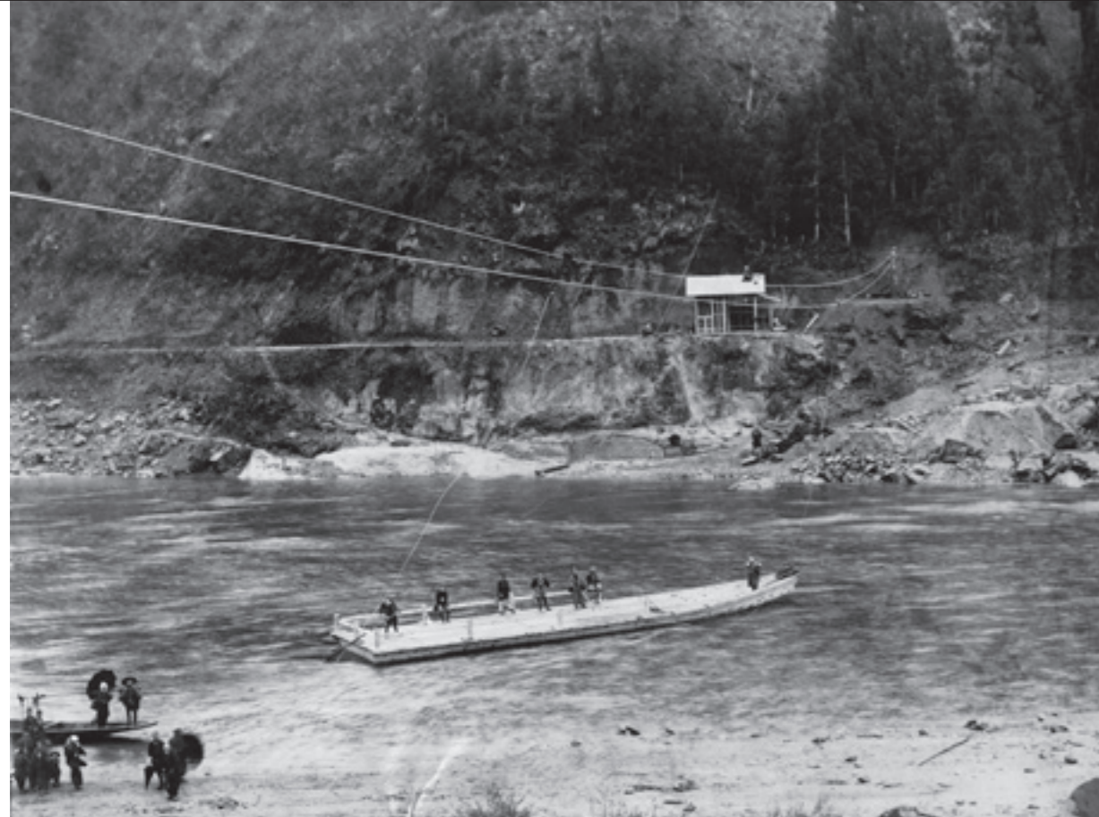
初代水沼橋流出後に活躍した「岡田式渡船」 馬車を2、3台は積むことができる大型の渡し船であった 金山町・水沼 1913～1925年頃
