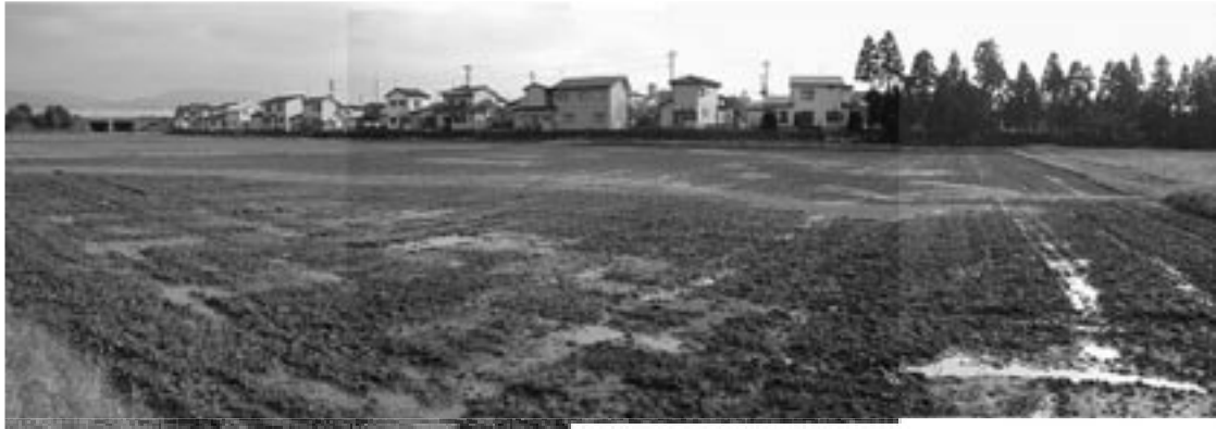
図-2 広範囲で発生している噴砂 最も液状化の激しかった所である。地震発生時には砂とともに大量の水が噴出した。
