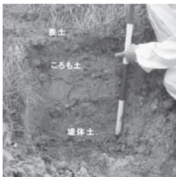
図2 No. 1地点における表土、ころも土および堤体土の地層構造
