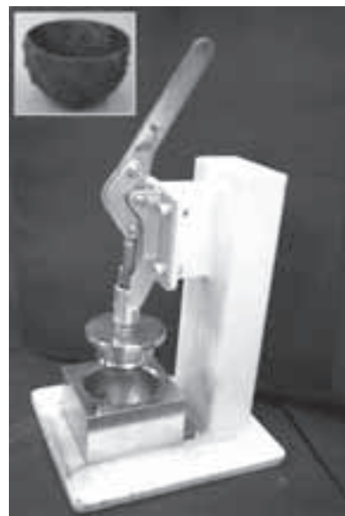
図6. 肥料カップ作製機と肥料カップ
