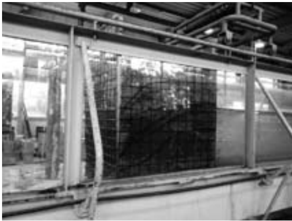
a 水路内に築造した砂礫堤体（右が上流側）
