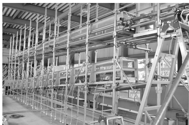
図 5 限界長を計測するための長さ10m の大型土槽試験装置
