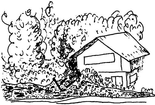
図-3 a 地面を流走する土石流の先端部 先端の舌状部が家屋の土台あるいは脚部 を破壊し、家屋上部構造は転回してつぶ れたものがある。
