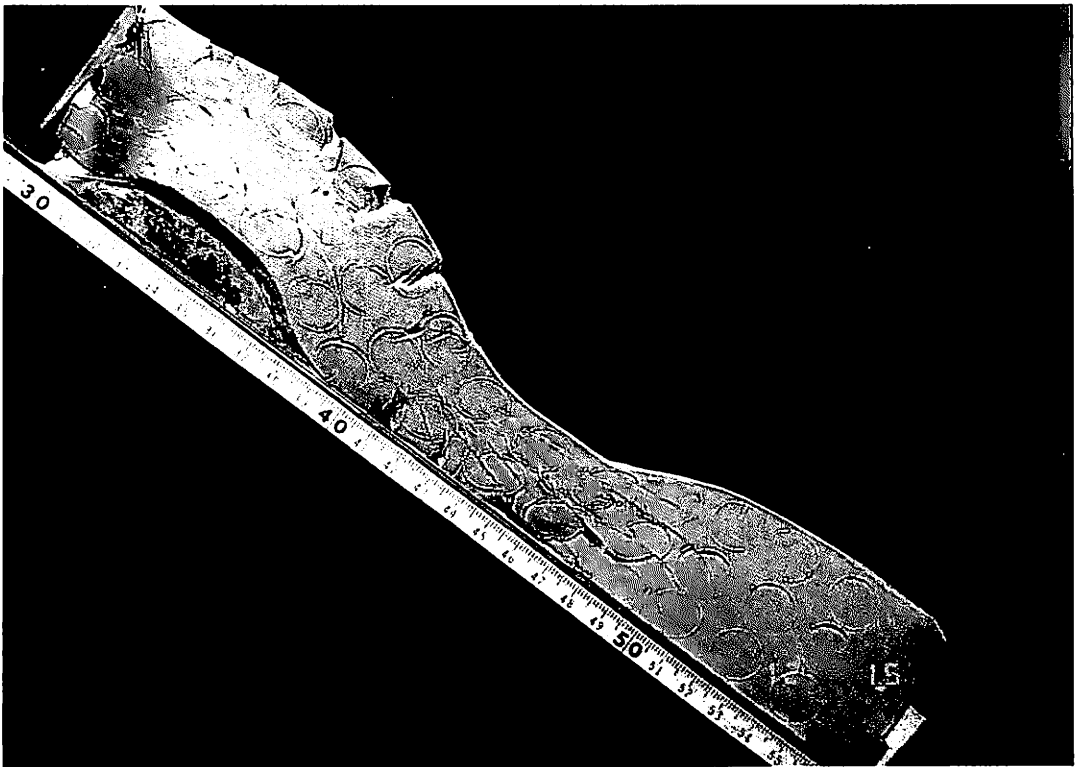
図-12 すべりおちたベントナイト粘土に生じた亀裂群 Fig.12 The crack on the bentonite clay caused sliding.
