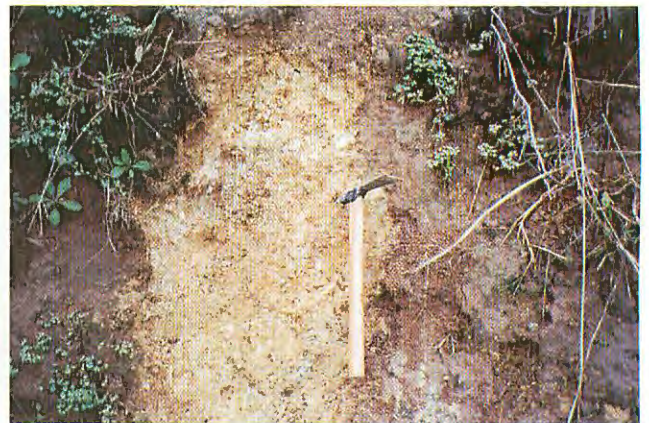
写真一14 巫山市街地. 固結した地すべり崩積土.
