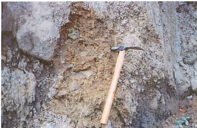
写真-7 奉節市街地、固結した地すべり崩積土、ハンマーで容易に崩れる。
