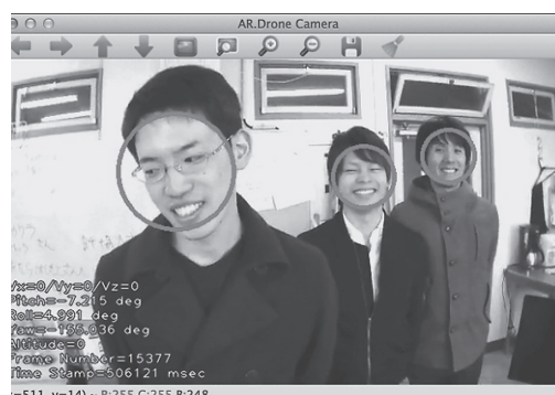
図3 OpenCV画像解析による顔画像認識
