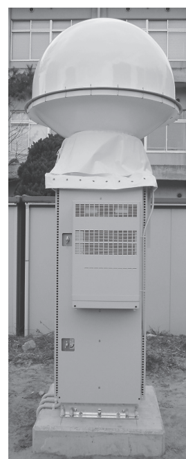
図1 導入された対流圏DBSシステム
