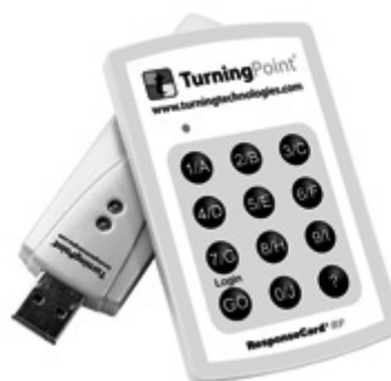
図2 クリッカー(右)と受信機(左)
