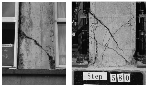
写真-1 新潟県中越地震における柱の被害の再現実験(左が実被害、右が再現実験)
