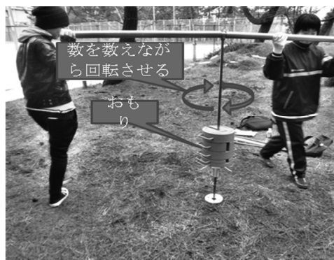
写真-7 スウェーデン式サウンディング試験の実施
