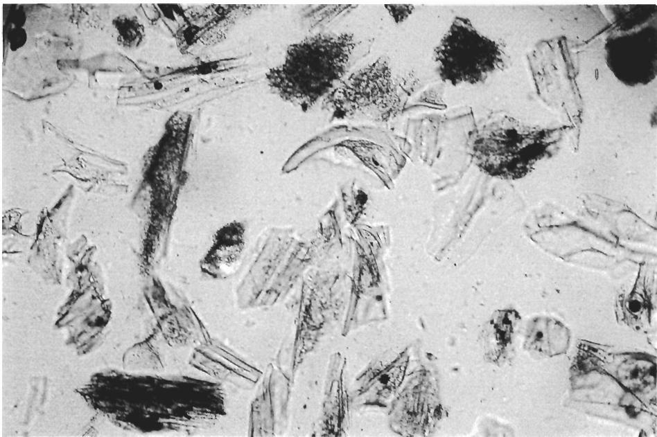
第15図 玉造ピンクテフラ層のユニットIのピンク部の構成粒子、ガラス質でガラスは薄手の bubble wall 型 や bubble Junetion 型が多い (大崎市鶴目)。
