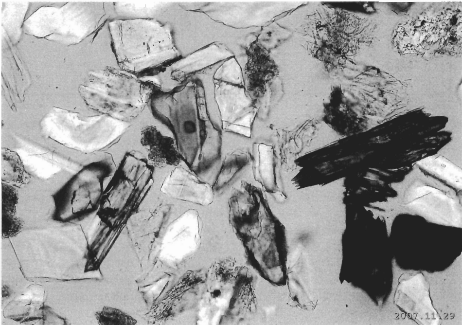
第9図 高浜白ゴマテフラ層 (Ths) の構成粒子. 斜長石結晶と有色鉱物が多く, 有色鉱物はそのほとんどが斜方輝石である.
