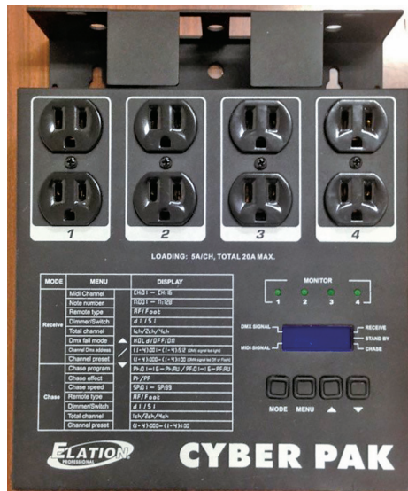
図 2 : CYBER PAK (ELATION製調光ユニット)
