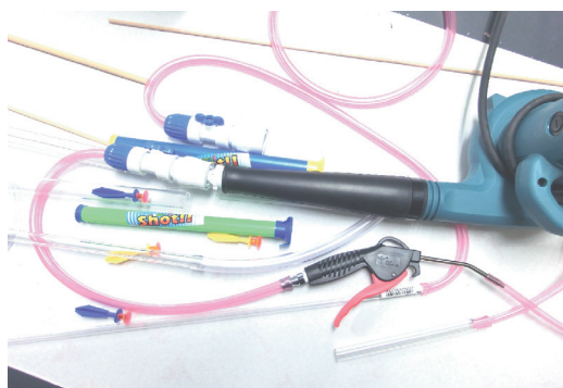
図2：ブロウ、吹き矢型物体、アクリルパイプ、 風力調整用の水道栓
