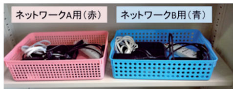
図7 ネットワーク色と同色のトレイに収められたICT機器一式
