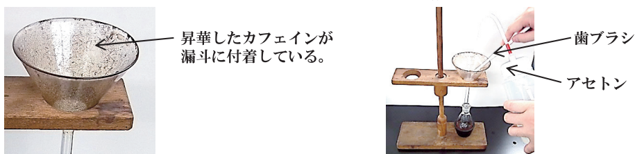
図1 実験方法：茶葉の直接加熱によるカフェインの昇華
